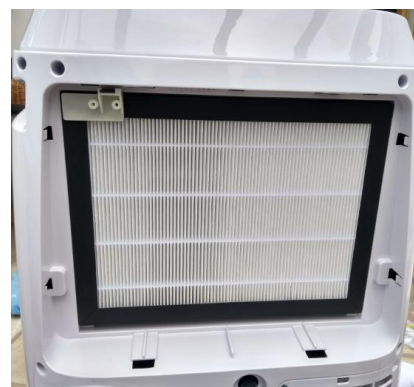
Filtro HEPA instalado
